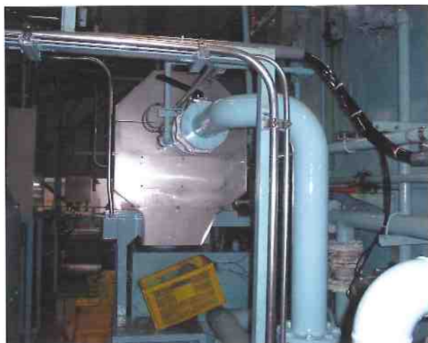
・洗ピン機ラベルかす除去に使用中 ドラムフィルター：DF-6090
