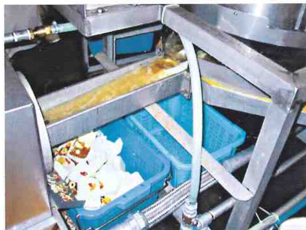
・弁当工場洗浄機の残菜類前処理 ドラムフィルター：DF-3045
